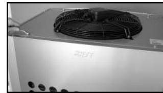
Irrota levyt irrottamalla ruuvit lämpöpumpun yläsivulta.
